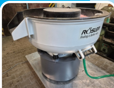
omílací stroj Rösler R220EC - ocel/nerez/hliník
